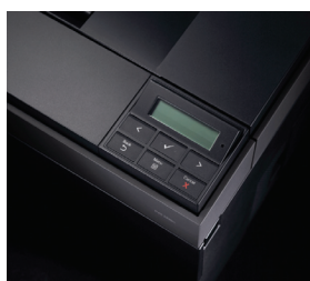
Panneau de commande de l'imprimante Dell 2350dn
